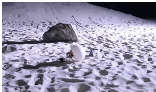
LEV-1 開発時の試作機「Hopping Rover」(地球上での実験環境で撮影)
